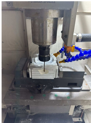
Gambar 3-12 Mengatur titik 0 pada benda kerja
