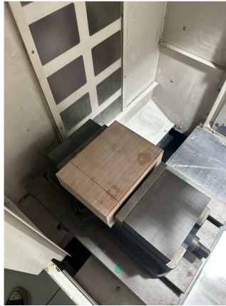
Gambar 3-9 Mencekam benda kerja pada ragum
