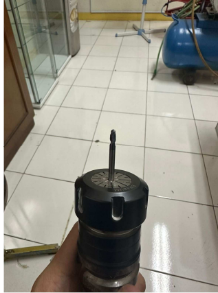
Gambar 3-11 Memasang mata pahat pada collet ER32
