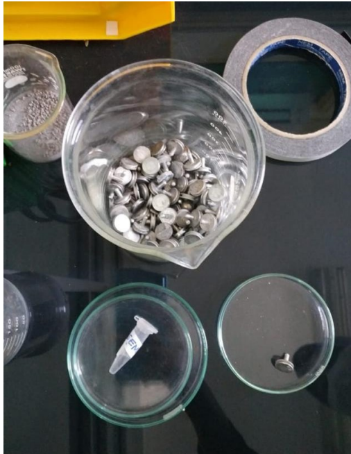
Persiapan sampel untuk pengujian SEM
