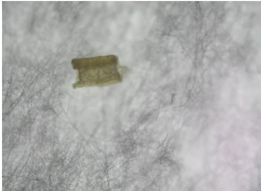
Gambar 4. 3 Warna Mikroplastik menggunakan Mikroskop Binokuler XSZ-10BN dengan perbesaran 10x: (a) Transparan; (b) Cokelat; (c) Merah; (d) Hitam; (e) Biru; (f) Hijau; (g) Kuning
