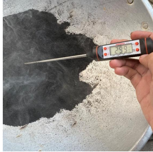
Kompos yang sudah disaring, lalu disangrai s/d suhu 300 °C selama 20 menit hingga menjadi arang kompos
