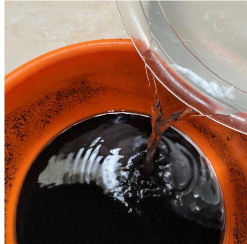
Penyucian arang kompos dengan air bersih dan aquades hingga pH arang kompos menjadi netral
