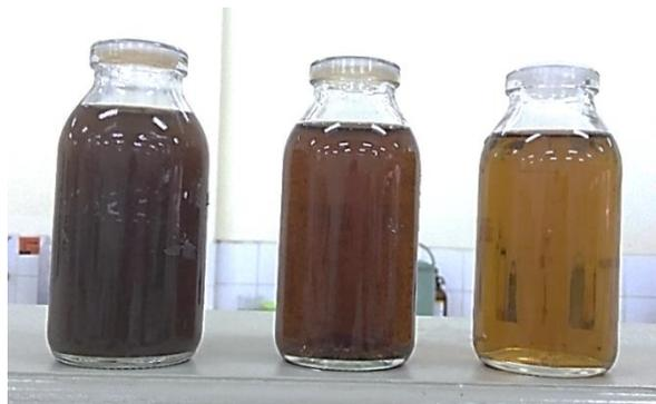
**Gambar 4.14** Perbandingan fisik dari *Input*, Kontrol dan *Output* dari Limbah Penyamakan Kulit dengan Penerapan Kombinasi Adsorpsi dan Fitoremediasi.
