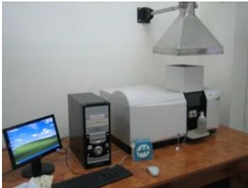
Pembacaan Nilai Konsentrasi Logam Kromium Total (Cr) menggunakan alat SSA (Spektrofotometer Serapan Atom)
