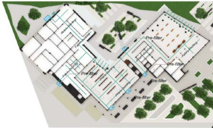
Gambar 4.31 Skema Ducting Bangunan (sumber : penulis)
