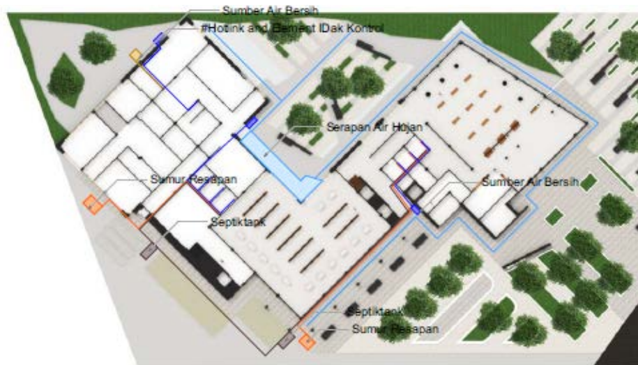
Gambar 4.32. Skema sanitasi bangunan (sumber : penulis)
