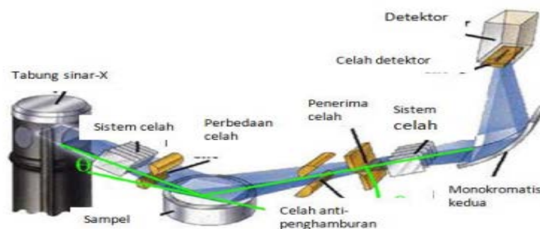
Gambar 4. Skema alat difraksi sinar-X (Abdulah, 2008).
