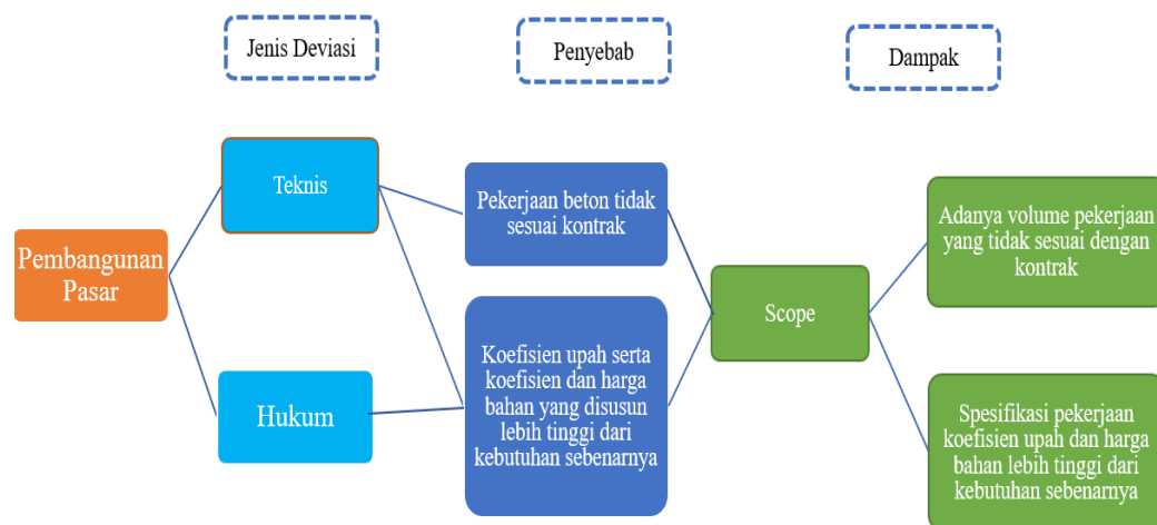
Gambar 5.13 Deviasi Pembangunan Pasar
