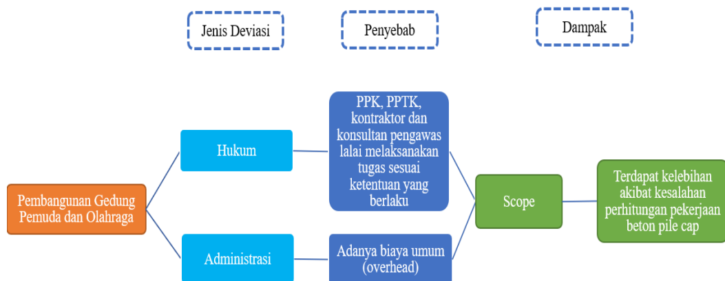
Gambar 5.3 Deviasi Pembangunan Gedung Pemuda dan Olahraga
