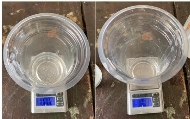
Gambar 3-27 Proses Pencampuran Epoxy dan Hardener
