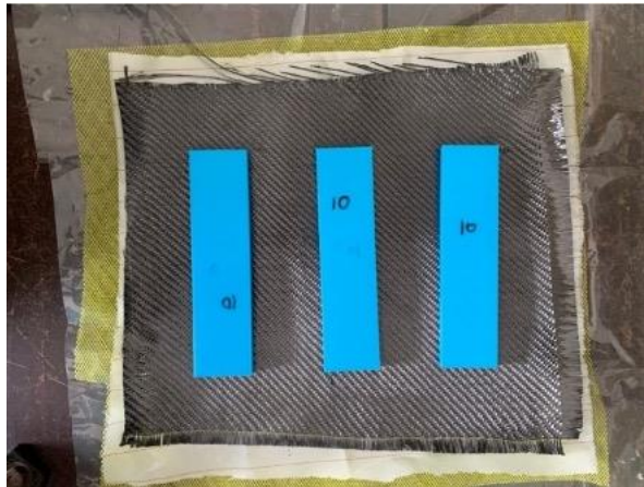
Gambar 3-22 Penyusunan Bahan Sebelum Vacuum
