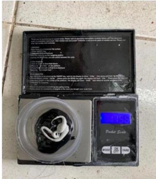
Gambar 3-24 Pencampuran Lem Dextone Dan Hardener
