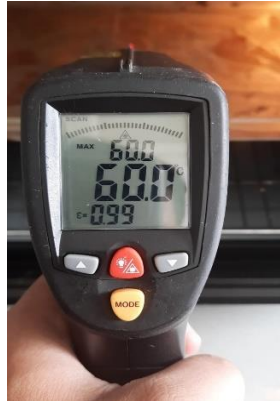
Gambar 3- 21 Proses Pengukuran Suhu Setelah 10 Menit Pemanasan
