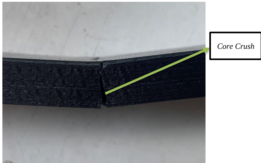
Gambar 4-10 Spesimen Tanpa Skin Karbon Pemanasan 2 Jam
