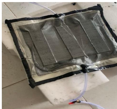
Gambar 3-31 Memasukkan Bahan Kedalam Vacuum Bag
