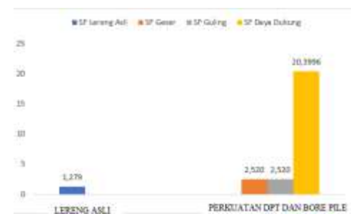
Gambar 13. Perbandingan Nilai Angka Aman Kondisi Eksisting dan Setelah Diberi Dinding
