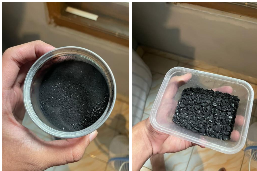
Gambar 2. 26 Bahan Halus dan Bahan Kasar Briket Arang Kelapa
