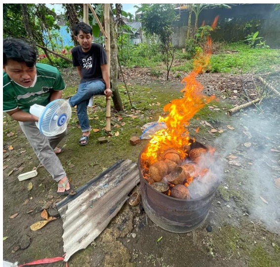
Gambar 2. 22 Proses Pembakaran Limbah Batok Kelapa
