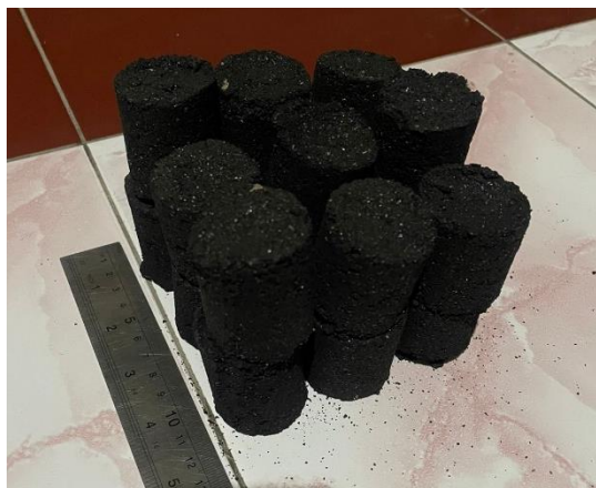
Gambar 2. 9 Penyusunan briket arang kelapa secara vertikal
