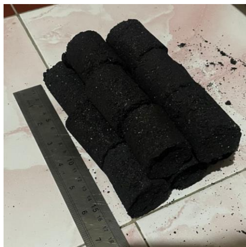
Gambar 2. 10 Penyusunan briket arang kelapa secara horizontal
