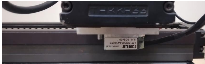
Gambar 3-7 Posisi Enkoder pada linier ball-screw
