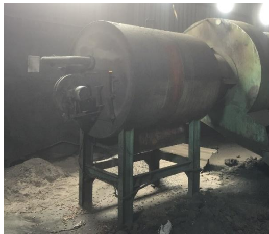
Gambar 4. 3 Proses Pengeringan Pupuk dengan Mesin Rotary Drying
