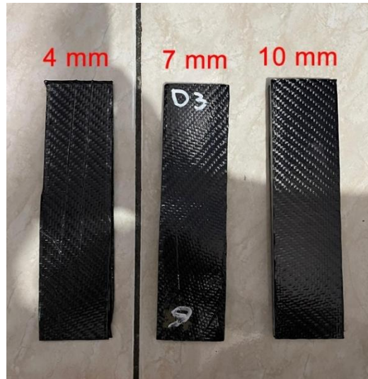
Gambar 4-1 Hasil Setelah Vacuum Bagging
