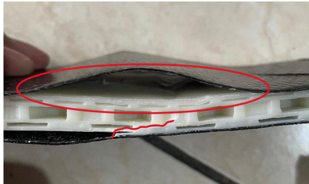
Gambar 4-8 Modus Kegagalan Spesimen C1
