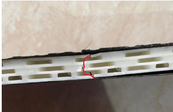
Gambar 4-6 Modus Kegagalan Spesimen B2
