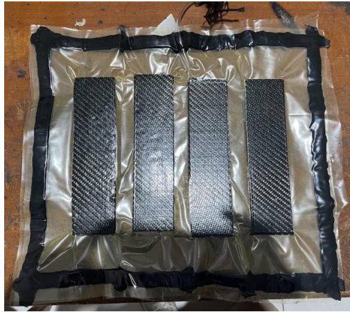
Gambar 3-26 Pemasangan Spesimen Pada Vacuum Bag
