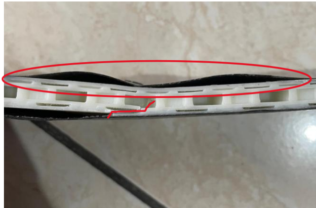
Gambar 4-10 Modus Kegagalan Spesimen C3
