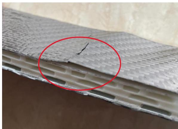
Gambar 4-5 Modus Kegagalan Spesimen B1
