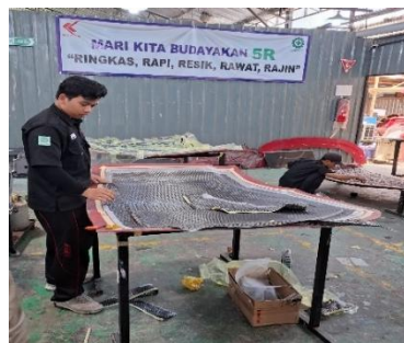
Gambar 4. 4 Aktivitas Penempelan Serat Karbon
