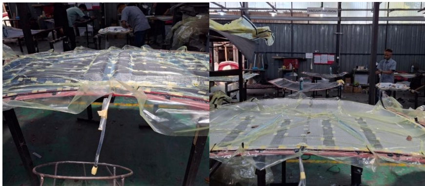
Gambar 4. 5 Aktivitas Proses Vacuum Infusione
