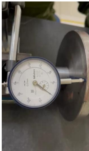
Gambar 3. 8 Pemasangan dial indicator pada disk
