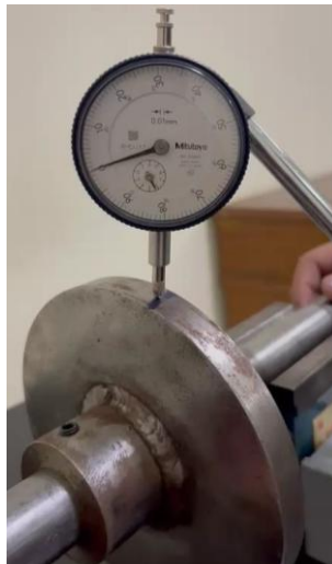
Gambar 3. 6 Pemasangan dial indicator pada disk
