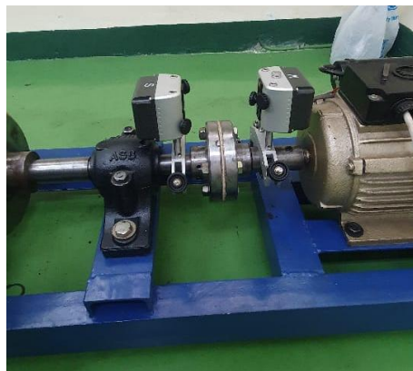
Gambar 3. 9 Pemasangan sensor SKF TKSA-51
