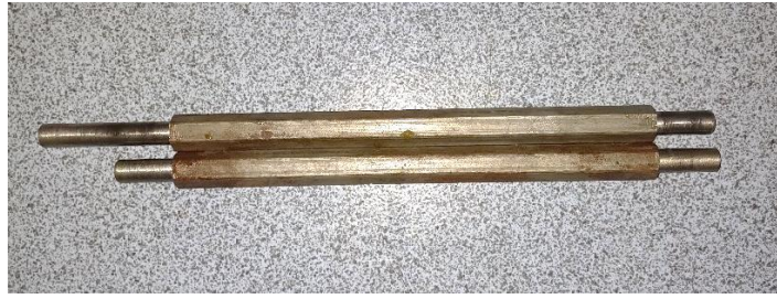
Gambar 4-3 Hasil pembubutan sisi kanan dan kiri shaft
