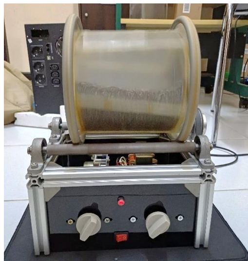
Gambar 4-18 Tumbler TRIZ berisi media abrasif berputar pada shaft
