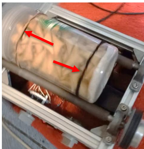
Gambar 4-16 Tangkapan layar video simulasi tumbler dengan tambahan grip
