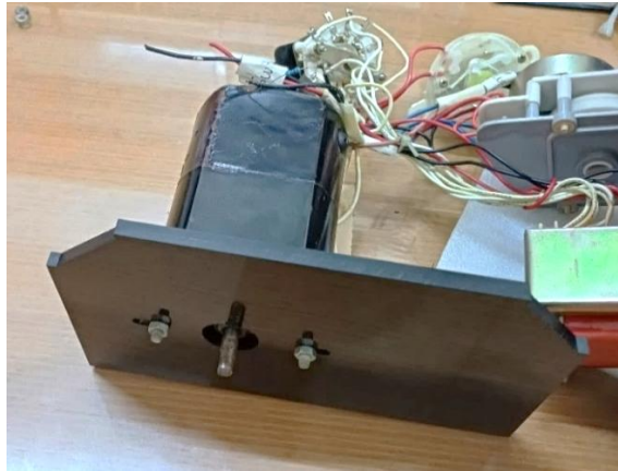
Gambar 4-7 Proses perakitan aktuator pada cover
