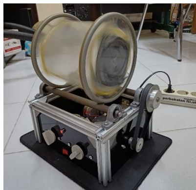
Gambar 4-12 Hasil uji mesin penggerak dengan tumbler TRIZ
