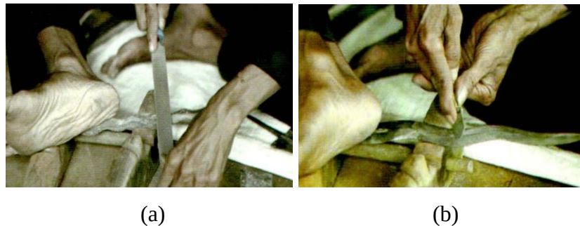
Gambar 2. 6 Contoh teknik pembuatan pamor (a). kikir, dan (b) ukir
