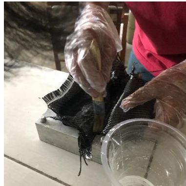
Gambar 3-21 Penyusunan Lapisan ( Stacking )
