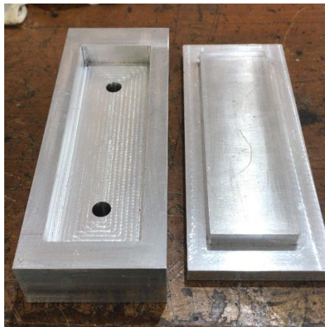
Gambar 3-7 Hasil Cetakan Spesimen
