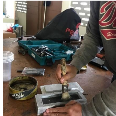
Gambar 3-11 Proses Laminasi Cetakan Spesimen
