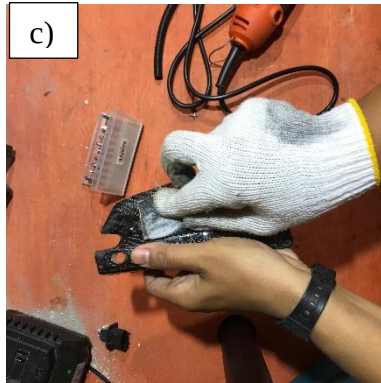
Gambar 3-24 Proses Finishing Produk a) Pemotongan Sisa Karbon; b) Proses Grinder; c) Proses Pengamplasan; d) Proses Pemolesan
