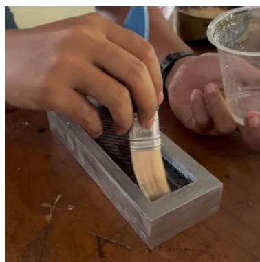
Gambar 3-12 Penyusunan Lapisan ( Stacking ) Spesimen
