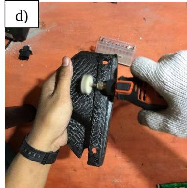
Gambar 3-24 Proses Finishing Produk a) Pemotongan Sisa Karbon; b) Proses Grinder; c) Proses Pengamplasan; d) Proses Pemolesan
