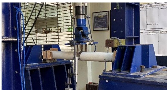
Gambar 2. Uji lentur dengan beban terpusat
