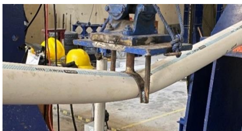
Gambar 11. Tipikal kerusakan batang lentur pasca diuji
