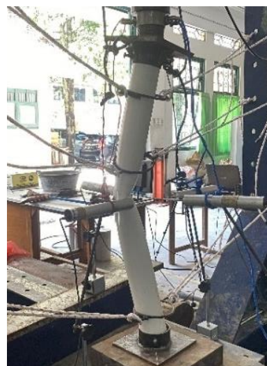
Gambar 8. Kerusakan sampel 2 pasca diuji tekan
