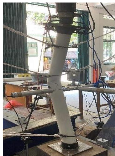
Gambar 7. Kerusakan sampel 1 pasca diuji tekan
