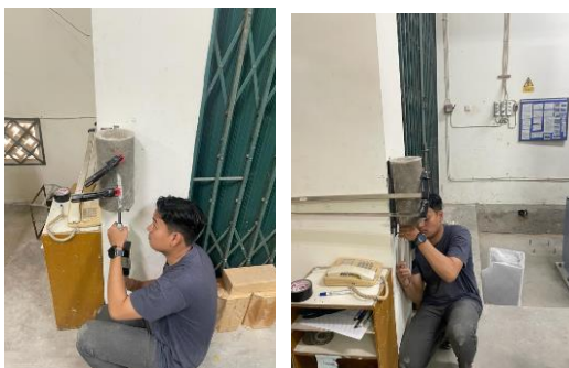
Gambar 3. Pengujian hammer test
