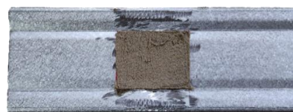
Gambar 8. Pengaplikasian adhesive epoxy
