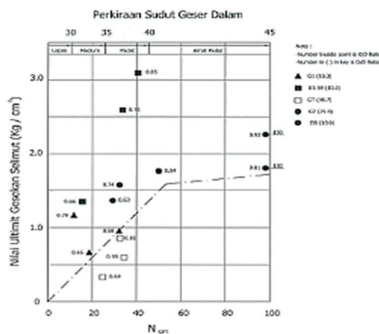
Gambar 2. Hubungan Tahanan Selimut Ultimate terhadap N_{SPT} (Sumber: Reese & Wright, 1977)
