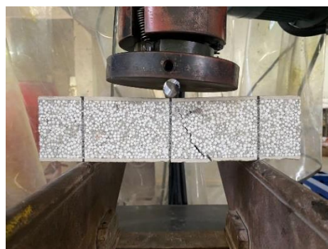
Gambar 4 Pengujian lentur material
