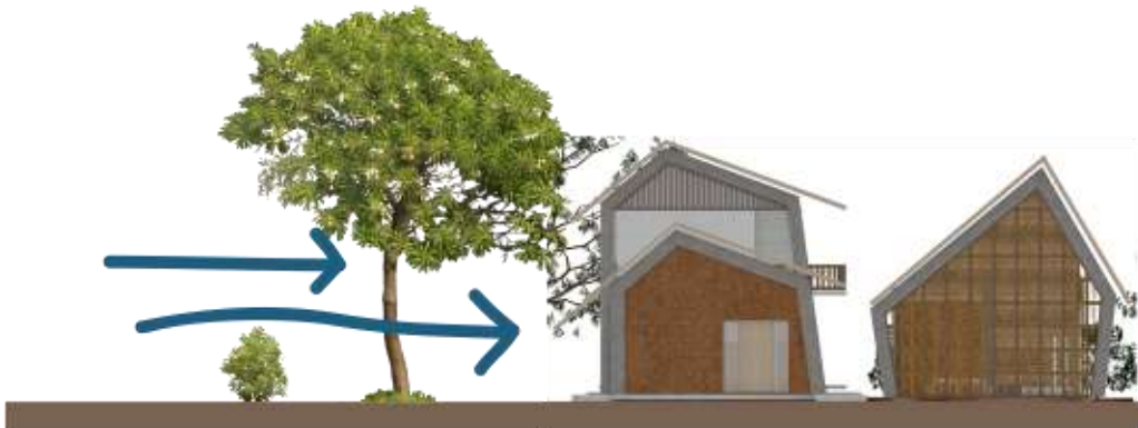
Gambar 6. 6 Skema Angin Pada Homestay Orientasi Barat/Timur
