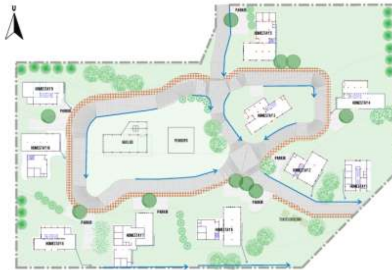
Gambar 5. 18 Skema Drainase Pada Site
