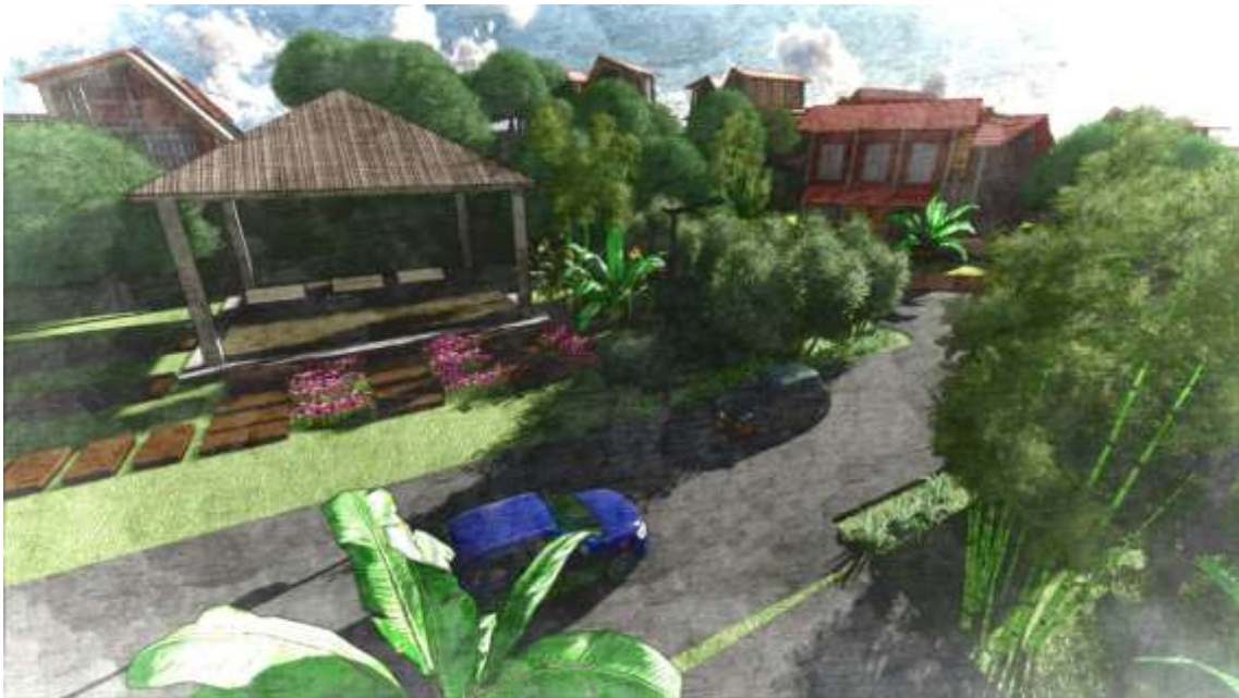
Gambar 5. 3 (Atas) Kondisi Eksisting (Bawah) Setelah di Redesain Gambar diatas menjelaskan kondisi jalan eksisting dan setelah di redesain. Terdapat beberapa perubahan seperti penempatan vegetasi dan pelebaran jalan yang sebelumnya hanya 3m menjadi 6m.
