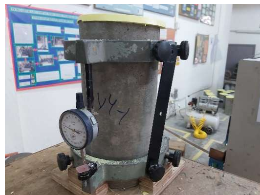
Gambar 6 Pemasangan dial gauge pada benda uji
