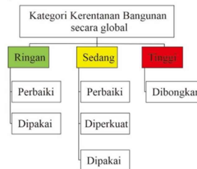
Gambar 23. Skema Penanganan Bangunan Secara Global (Sumber: Sarwidi, 2024)
