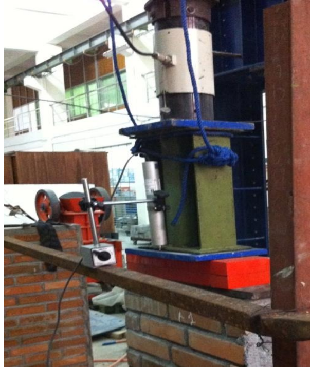
Gambar L-6.1 Pemasangan LVDT Untuk Pengujian Tekan Dinding
