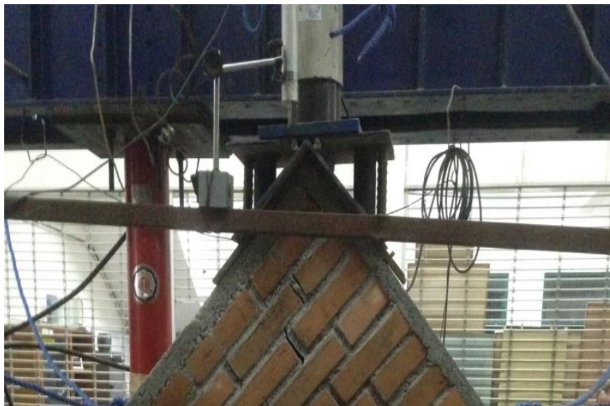
Gambar L-6.2 Pemasangan LVDT Untuk Pengujian Geser Diagonal Dinding
