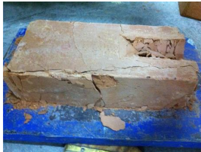
Gambar 5.28 Hasil Pengujian Tekan Unit Bata-kait
