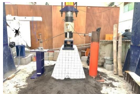
Gambar 3. Pengujian Kuat Desak
