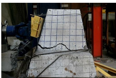
Gambar 6. Pengujian Kuat Desak
