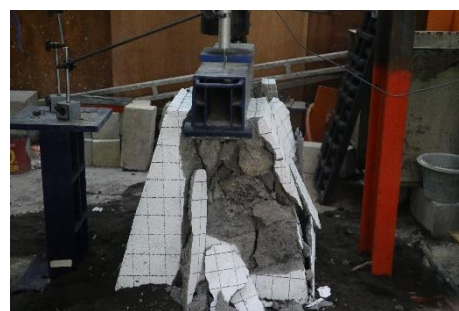
Gambar 4. Sampel Uji Desak Pada Beban Maksimum
