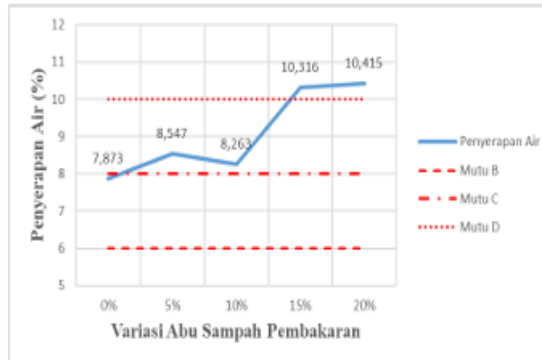
Gambar 6. Grafik Hasil Pengujian Penyerapan Air Paving block
