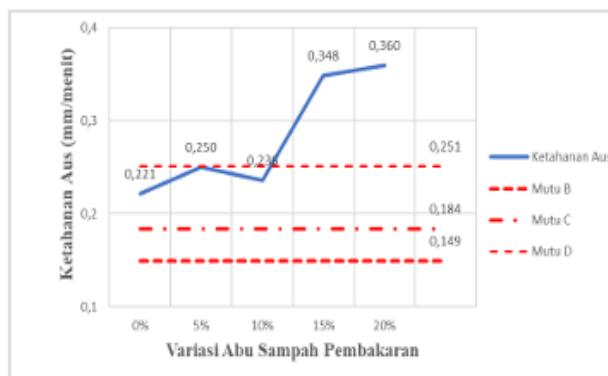
Gambar 9. Grafik Hasil Pengujian Ketahanan Aus Paving block
