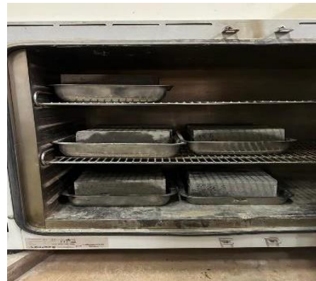
Gambar 7. Pengujian Penyerapan Air
