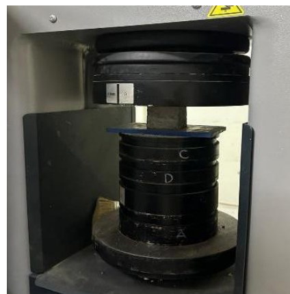
Gambar 5. Pengujian Kuat Tekan
