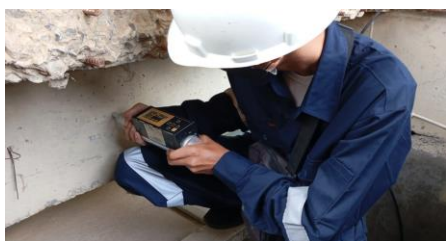
Gambar 9. Pelaksanaan uji non-destruktif schmidt rebound hammer
