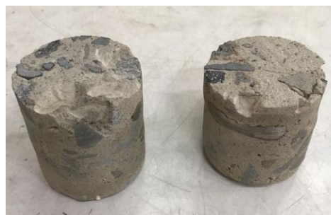
Gambar 14. Hasil pengambilan sampel beton inti ( core drill ) elemen struktur pelat
