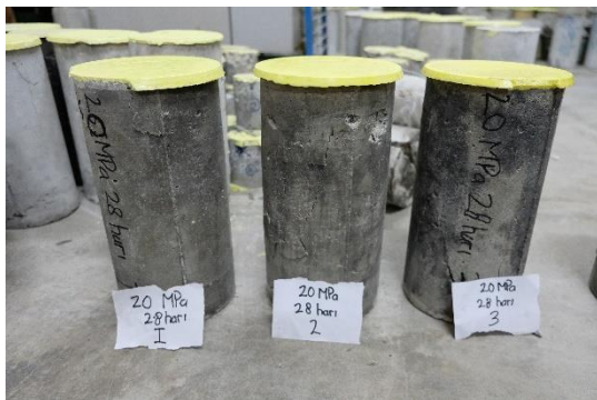
Gambar 7. Benda Uji Silinder Setelah Pengujian
