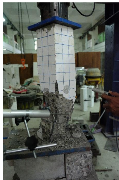
Gambar 8. Benda Uji kolom Setelah Pengujian
