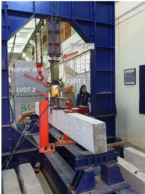
Gambar 3. Detail setup pengujian
