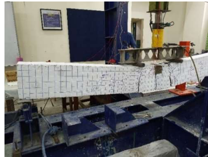
Gambar 5. Keruntuhan Tipikal Balok 1&2
