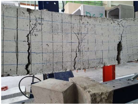
Gambar 8. Tipikal pola retak balok 5
