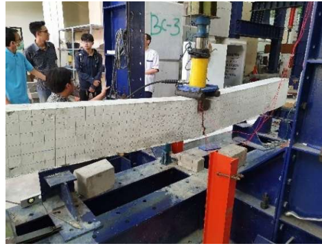
Gambar 11. Keruntuhan Tipikal Balok 7
