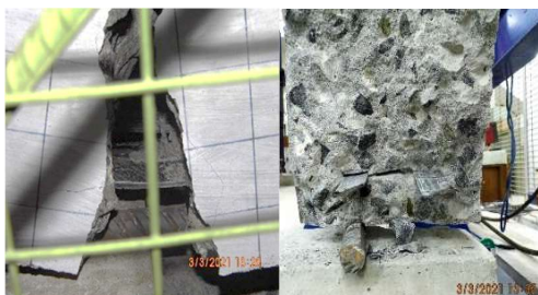
Gambar 11. Tipikal tulangan CFRP yang tidak putus
