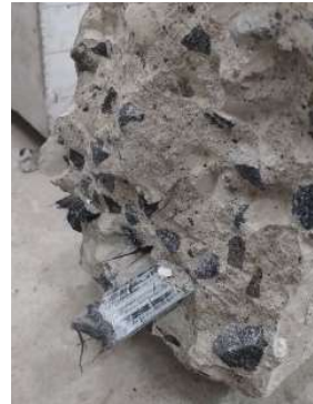
Gambar 12. Seluruh tulangan CFRP pada BVI-3 putus
