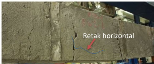
Gambar 10. Tipikal pola retak horizontal pada BVI
