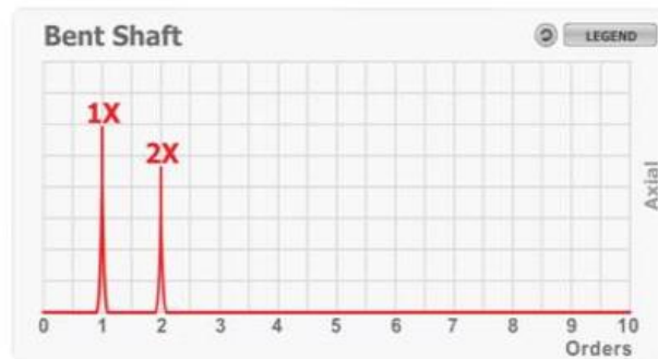
Gambar 2. 43 Spektrum vibrasi pada poros bengkok (Rizqullah, 2017)
