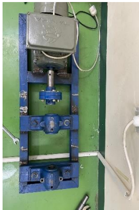
Gambar 3. 20 Pemasangan bearing house ke alas
