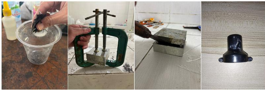
Gambar 4-20 Proses Pencetakan Produk Komposit
