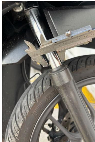
Gambar 4-1 Pengukuran pada shockbreaker depan Honda Beat Fi
