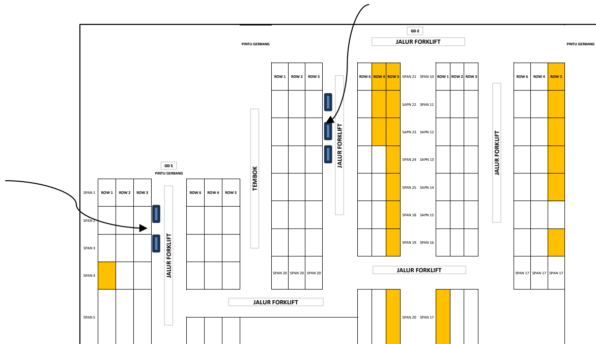
Gambar 4. 20 Rencana Penempatan / tata letak buffer area coil outbond di Gudang Luar PT. KAL
