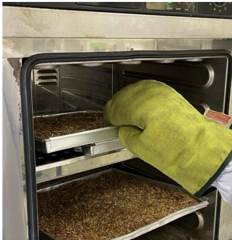
Mengeringkan sekam padi menggunakan oven dengan suhu 110° C
