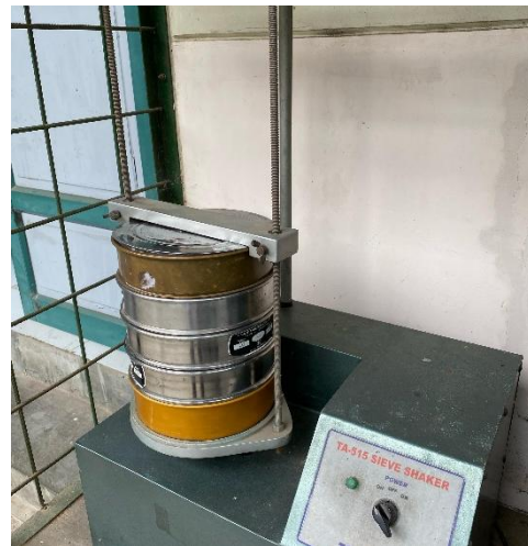
Proses pengayakan biochar untuk mendapatkan ukuran 70 mesh
