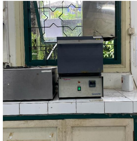
Sekam padi dimasukan ke dalam furnace dengan suhu 400° C
