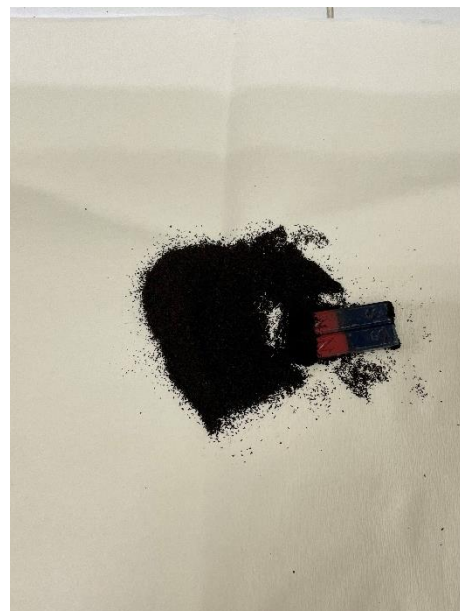
Menguji Sifat Kemagnetan Biochar Modifikasi
