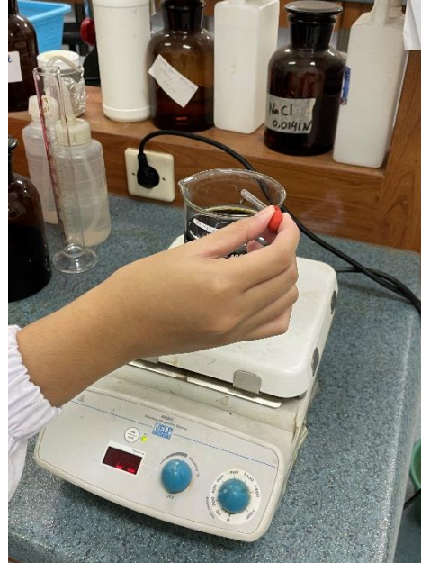
Penambahan NaOH pada Proses Modifikasi
