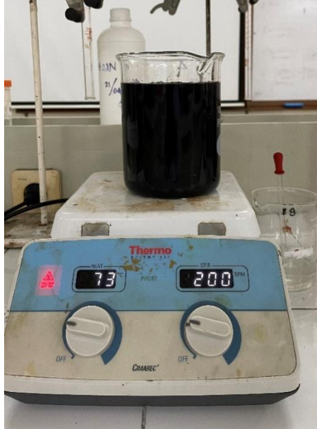
Modifikasi Biochar Sekam Padi dengan Magnetit
