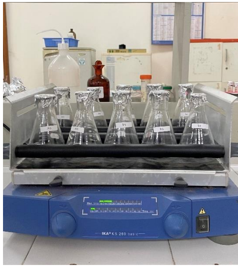
Pengadukan Larutan dan Adsorben dalam Proses Adsorpsi
