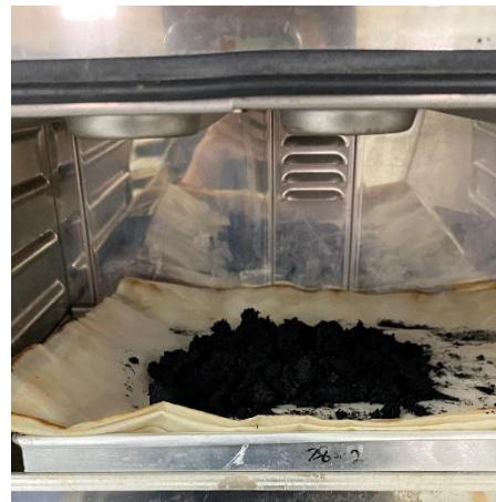
Pengeringan Biochar Sekam Padi Setelah Aktivasi dan Pencucian
