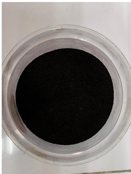
Biochar Sekam Padi yang telah dimodifikasi dengan Magnetit
