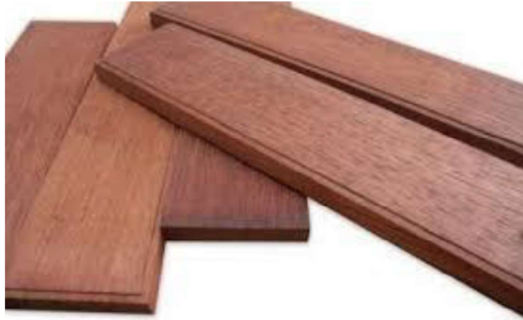
Gambar 6.7 Kayu Merbau untuk Struktur Dalam
