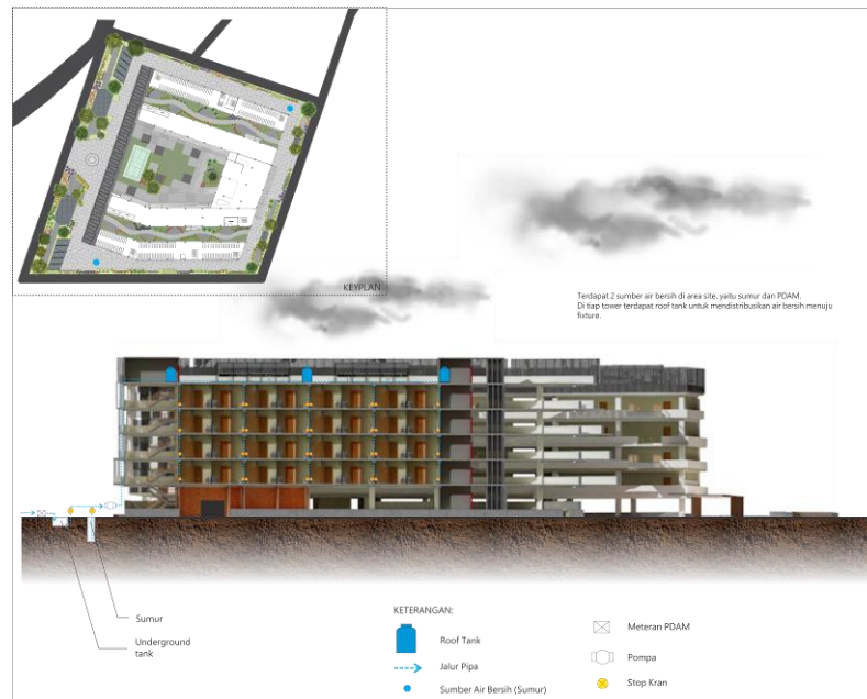
Gambar 5.23 Skema penyediaan air bersih pada bangunan Sumber: Analisis Penulis, 2018
