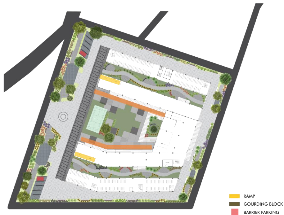
Gambar 5.21 Skema barrier free design Sumber: Analisis Penulis, 2018
