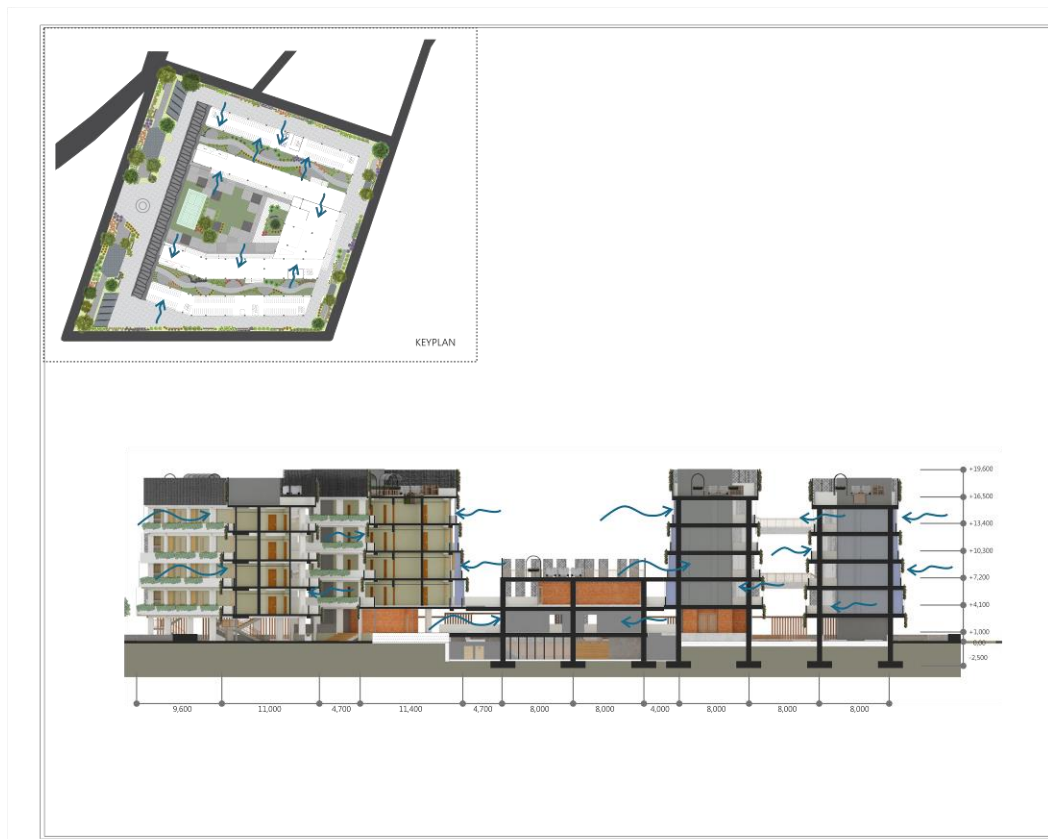
Gambar 5.22 Skema penghawaan pada bangunan Sumber: Analisis Penulis, 2018
