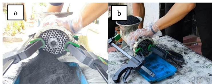
Gambar 3 - 4 (a) Penggilingan Arang; (b) Serbuk Arang
