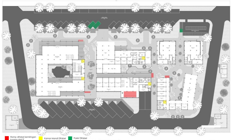
Gambar 4. 14 Fasilitas untuk penyandang difabel
