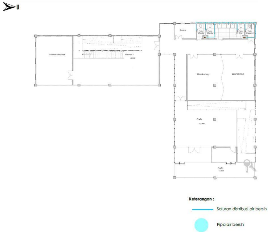
Gambar 5. 13 Sistem Distribusi Air Bersih
