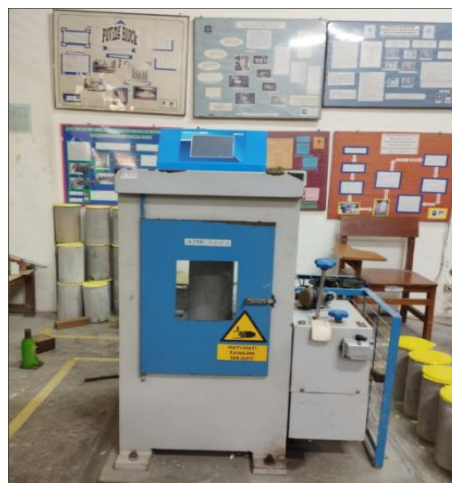
Gambar 5. 11 Pengujian Kuat Tekan
