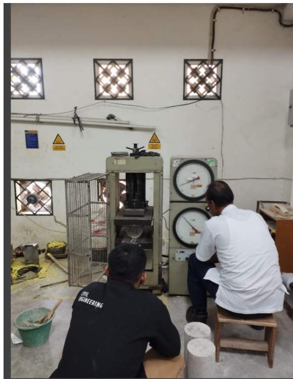
Gambar 5. 14 Pengujian Kuat Tarik Belah Beton
