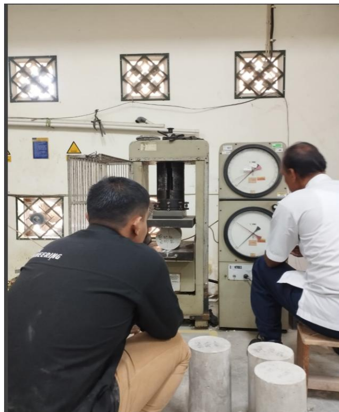
Gambar 6.4 Proses Uji Kuat Tarik Belah Beton
