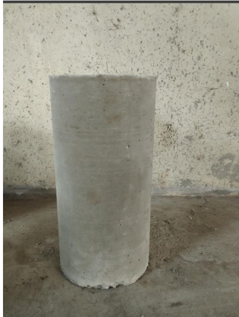
Gambar 7.1 Benda Uji Silinder 15 X 30
