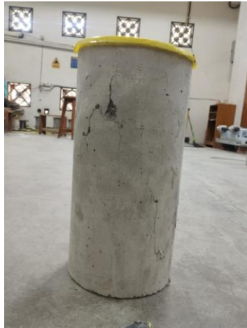
Gambar 5. 12 Benda Uji Setelah Pengujian Kuat Tekan Beton
